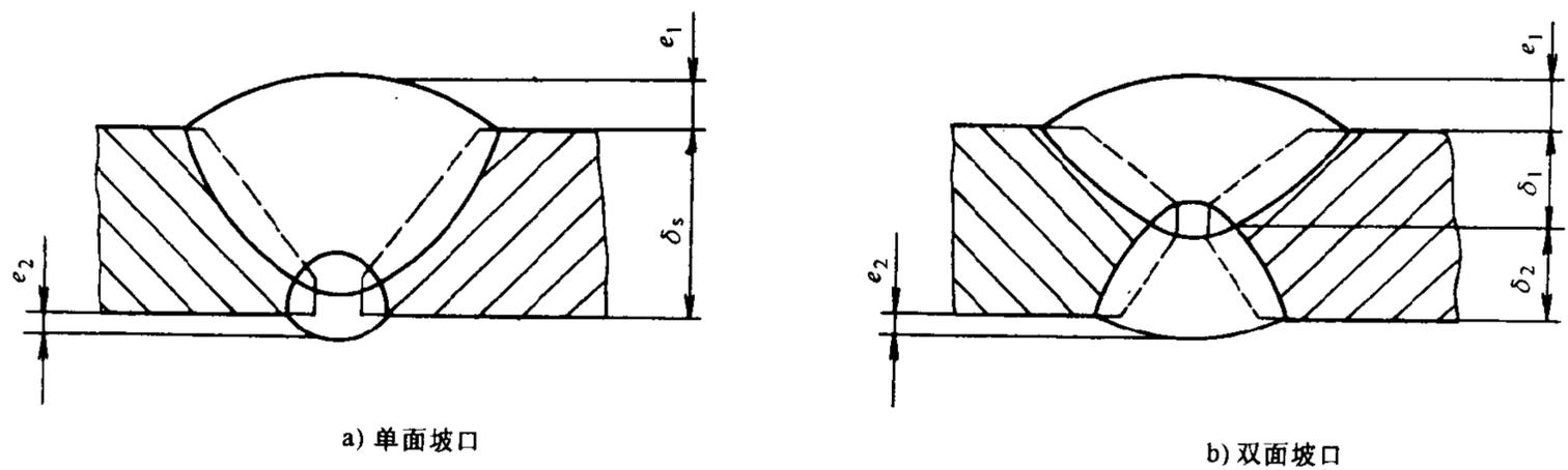
图 18 A、B 类接头焊缝的余高
