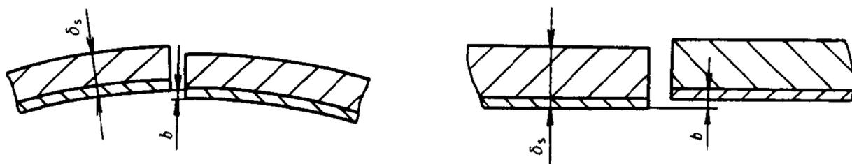
图 12 复合钢板的对口错边量
