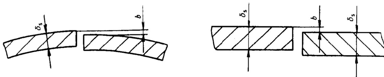
于10mm，两板厚度差超过3mm；若薄板厚度大于10mm，两板厚度差大于薄板厚度的30%，或超过5mm时，均按图13的要求单面或双面削薄厚板边缘，或按同样要求采用堆焊方法将薄板边缘焊成斜面，削薄长度 $L$ 至少为削薄厚度（厚板和薄板之差）的3倍。
