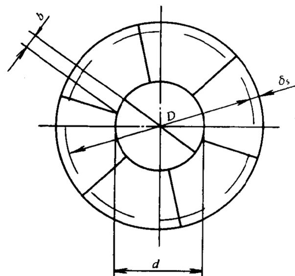
图6 瓣片和顶圆板拼接封头
