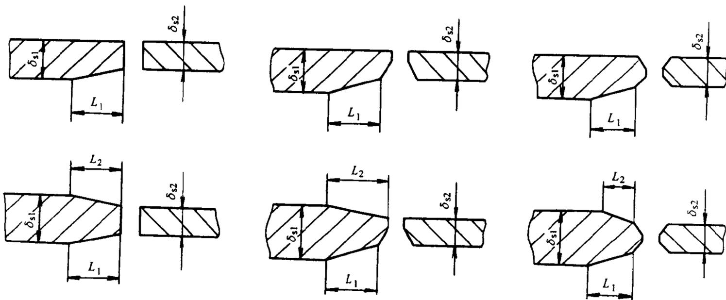
当两板厚度差小于上列数值时，则对口错边量 $b$ 按8.1.6要求，且对口错边量 $b$ 以较薄板厚度为基准确定。在测量对口错边量 $b$ 时，不应计入两板厚度差值。
